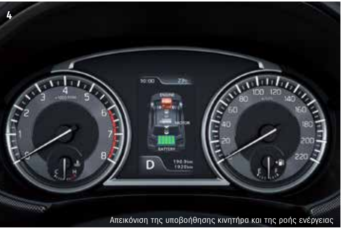
Απεικόνιση της υποβοήθησης κινητήρα και της ροής ενέργειας
